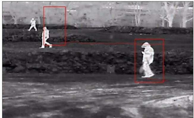
*Strelstest für die Videoanalysen – nicht ein, sondern mehrere Täter durchdringen den Perimeter. Der Alarmrahmen legt sich über zwei Täter und die Täter-Bewegungsrichtungsanzeige ist aktiv. Fotos: STYX*
