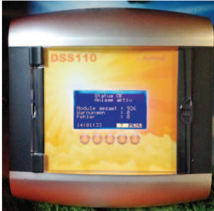
In der Zentrale laufen die ID-Codes zusammen. Fehlt ein Code, gibt das Gerät Alarm.
